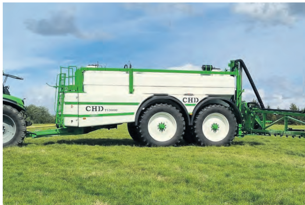
CHD's tandemsprøjter har lavt trækkræftsbehov. En 14.000 liter udgave er i drift i meget kuperet terræn i det østjyske med blot en 185 hk traktor.
