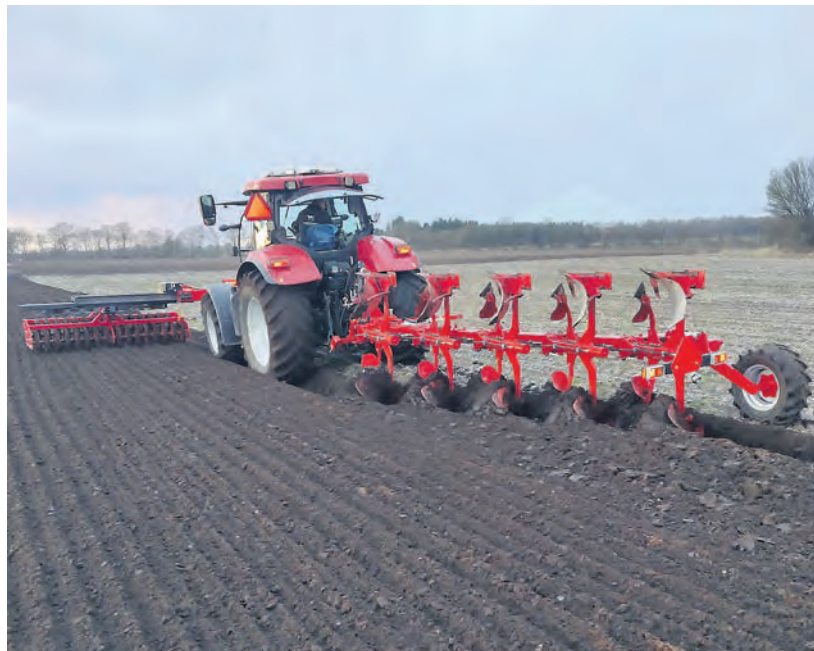
Ploveksperten kommer til Dansk Markdemo med blandt andet denne femfurede Ovlac Xperience med Kvik-pak foran.
