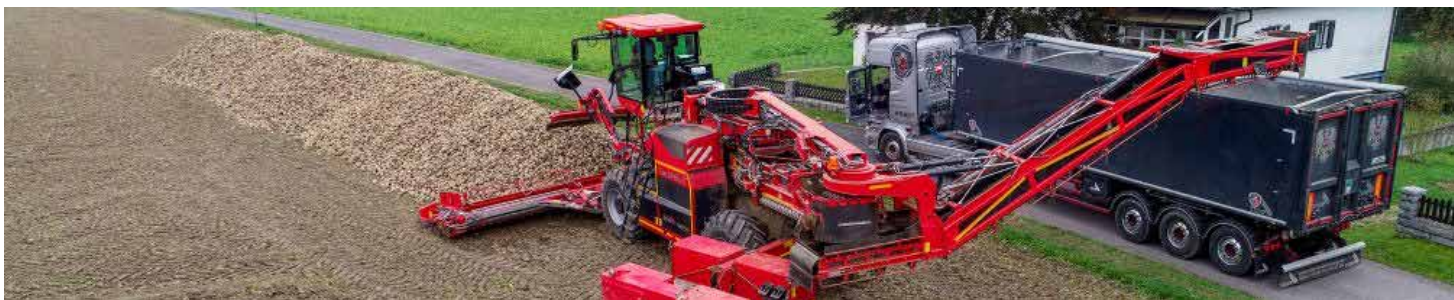
Holmer Felis 3 EVO er en rense- læsemaskine der er mere end 12 m lang. Foto: Holmer Maschinenbau GMBH.
