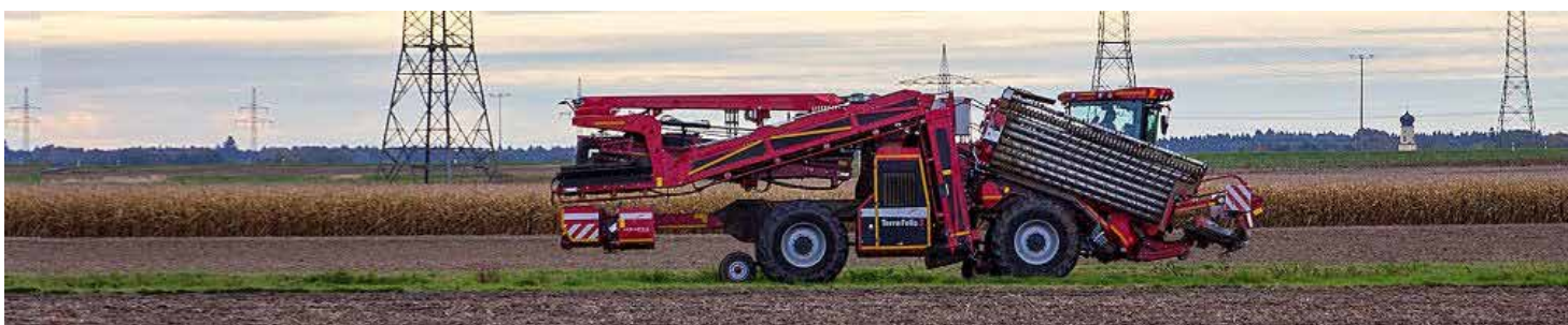
Holmer Felis 3 EVO sammenklappet til vejtransport er 14,8 m lang. Foto: Holmer Maschinenbau GMBH.
